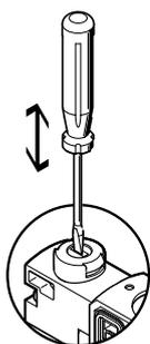
HHB wird durch Drücken mit Stift oder Schraubendreher betätigt und über Federkraft zurückgestellt.
