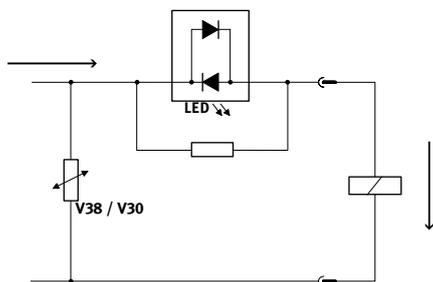
Jede Magnetspule ist mit einer Schutzbeschaltung zur Funkenlöschung und gegen Verpolung gesichert.
