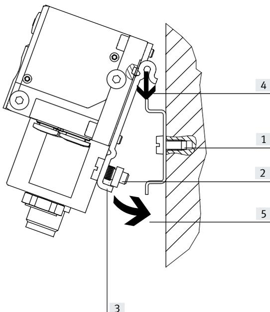
Die CPV-SC Ventilinsel wird in die Hutschiene eingehängt → Pfeil [4].
