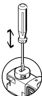
HHB wird durch Drücken mit Stift oder Schraubendreher betätigt und über Federkraft zurückgestellt (rastende Stellung wird durch codierte Abdeckkappe verhindert).
