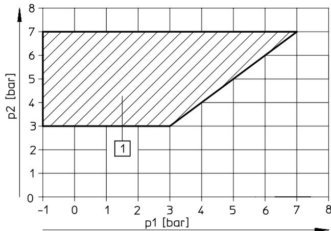
[1] Arbeitsbereich für Ventile mit Steuerluftversorgung, extern
