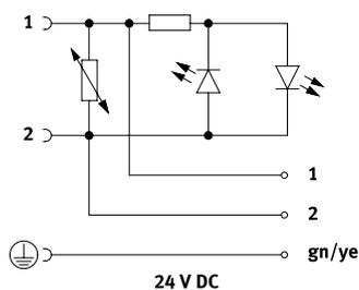
Die Ausführung für 24 V DC ist verpolungssicher und hat eine Schutzbeschaltung gegen Spannungsspitzen bis 100 V DC, sowie eine Betriebsanzeige mit gelber Leuchtdiode.
