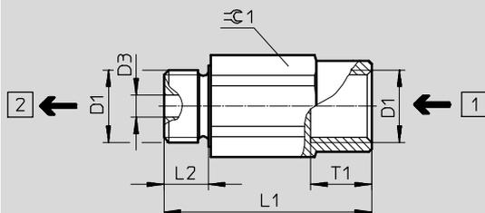
ISV-M4/M6/M10 für Vakuumsauggreifer
